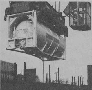
port von rieselfähigen Gütern, die mit einem Betriebsdruck von 2 bar entleert werden, sind bei der Firma Cargowaggon GmbH, Frankfurt, im Einsatz. Es handelt sich hierbei um 20'-Container (etwa 6,1 m) mit einer Außenbreite von 2500 mm mit dem bewährten Auslauf aus dem kippbaren Silo-Programm, der eine ausgezeichnete Restlosentleerung gewährleistet.
