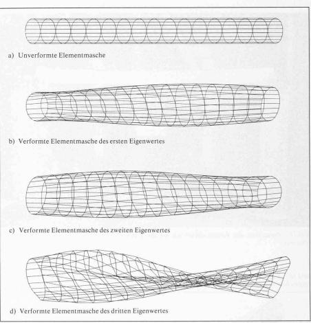
Bild 9. Elementmasche der Finiten Element Berechnung der Antriebswelle
