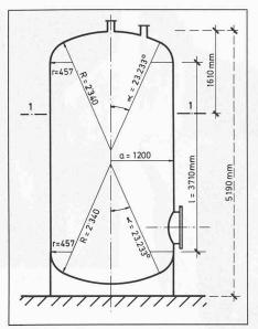
Bild 13. Geometrie des stehenden Tanks aus GFK [9]
