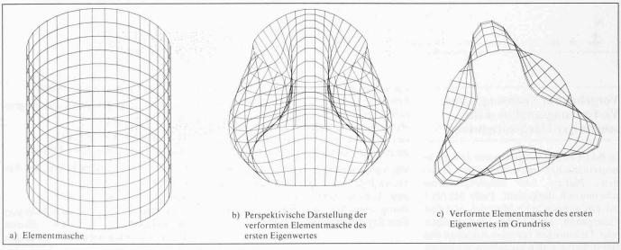
Bild 7. Elementmaschen der Finiten Element Berechnung des Kreiszylinders
