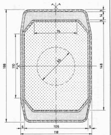
Bild 10. GFK-Kastenträger
