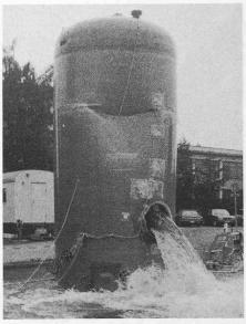
Bild 14. Beulen des stehenden Tanks aus GFK infolge Innenunterdruck
