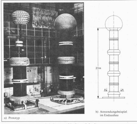
Bild 5. Prüftransformator in Kaskadenbauweise (Ciba-Geigy AG, Basel)
