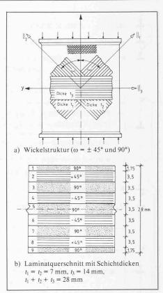
Bild 6. Aufbau der Kreiszylinder
