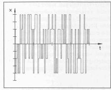
Bild 5. 5-wertiges pseudostochastisches Eingangssignal.
