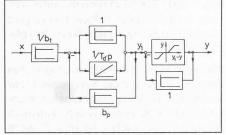
Bild 3. Signalflussplan eines idealisierten PI-Reglers mit bleibendem P-Grad und in Reihe geschaltetem, einfachem hydraulischen Verstärker.
