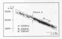
Bild 1. Aufzeichnung der Netzfrequenzschwankungen über der Bewegung des Stellgliedes, hier einer der vier Düsen einer Peltonturbine
