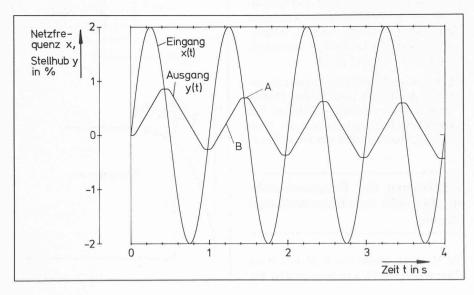
Bild 7. Einschwingungsvorgang bei der Direktmessung des Frequenzganges, Einfluss der Nichtlinearität. A Einfluss der Unempfindlichkeit, B Einfluss durch Begrenzung der Stellgeschwindigkeit.
