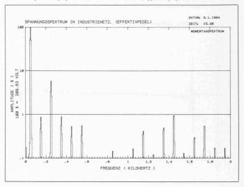
ben, da alle Abweichungen von der idealen Kurvenform (Bilder 1 bis 4) mit ihr in messbare Elemente zerlegt werden können. Massnahmen gegen Kurvendeformationen, also gegen unerwünschte Komponenten, werden logischerweise zuerst bei den am meisten störenden Teilkomponenten ergriffen.
