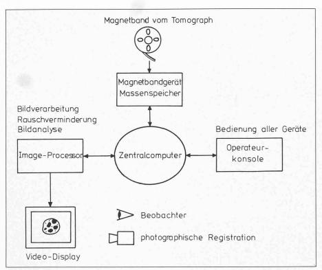
Bild 5. Typische Konfiguration einer modernen Bildverarbeitungsanlage
