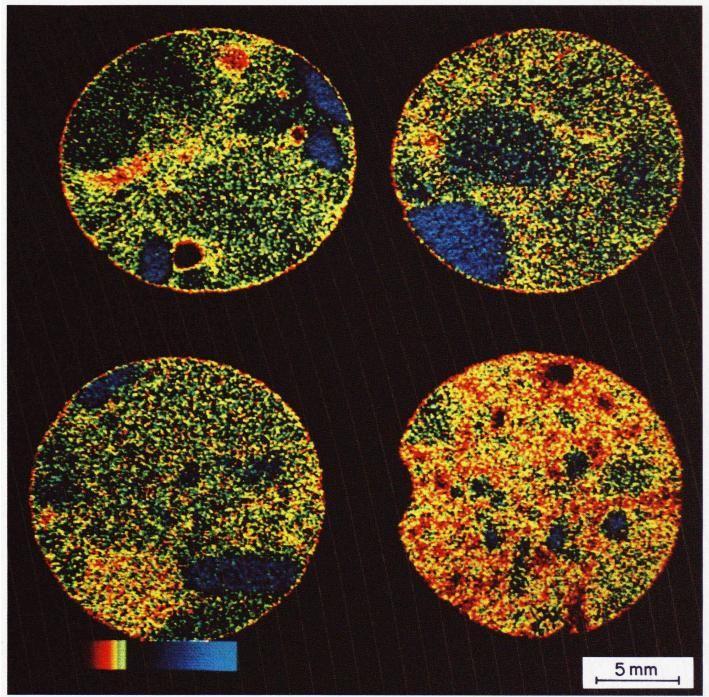
$Oben \ rechts \ Normalbeton \ W/Z = 0.57, unten \ links \ Normalbeton \ W/Z = 0.57, unten \ rechts \ Luftporenbeton \ mit \ 5\% \ LP, oben \ links \ befindet \ sich \ ein \ weiterer$ Normalbeton ohne weitere Angaben.
