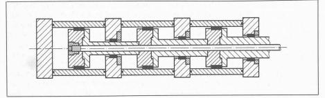
Bild 6. Schematische Darstellung des hydraulischen Mehrfachzylinders, der eine gestreckte, schlanke
