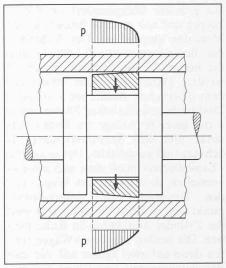
Funktionsprinzip des schwebenden Kolbenringes. Durch die Änderung der Verteilung des Druckes p bei unsymmetrischer Lage des Ringes erfährt dieser eine zentrierende Kraft in Pfeilrichtung. Die Konizität ist im Bild um mehrere Zehnerpotenzen übertrieben dargestellt
