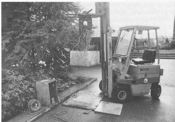
Bild 2. Der an einer Ausklinkvorrichtung hängende Betonquader wurde mit einem Hubstapler auf die notwendige Fallhöhe angehoben
