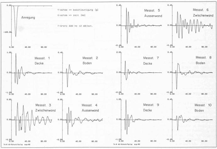
Bild 5. Beispiel von Messresultaten (Schwingungsmessungen San Hi Buchholz)
