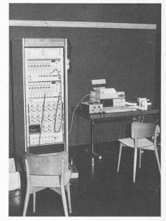
Verstärkungs- und Registrierelemente. Im Rack sind die Ladungsverstärker (unten) und die Transient-Recorder (oben) eingebaut. Rechts der Tischrechner HP 9826
