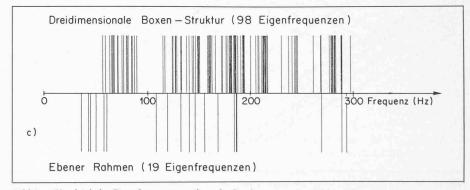
$Bild\ 4c. \quad Vergleich\ der\ Eigenfrequenzverteilung\ der\ Strukturen\ gem\"{ass}\ Bild\ 1\ und\ 3$
