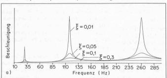
Bild 4b. Frequenz-Response des ebenen Rahmens gemäss Bild 1
