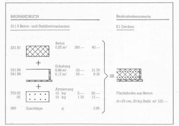
Bild 7. Beispiel für Aufteilung und Kennzeichnung der Ausmasse im Leistungsverzeichnis. E4 Aussenwände, E6 Innenwände
