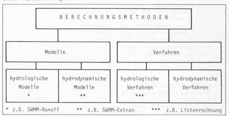
bei dem die Sätze von der Erhaltung der Masse und der Energie gelten. Das Abflussgeschehen kann mathematisch durch die Differentialgleichungen von St. Venant beschrieben werden. Es handelt sich bei diesen Differentialgleichungen um eine Kontinuitäts- und eine Bewegungsgleichung.
