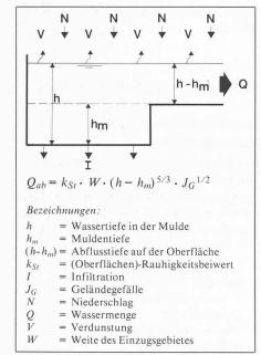
Bild 4. Oberflächenabfluss
