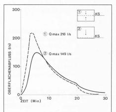
Das Bild zeigt deutlich, wie die Lage des Kanals den Oberflächenabfluss beeinflussen kann. Speziell die Maximalwerte weichen stark voneinander ab (im vorliegenden Beispiel  $Q_{max, 2} = 70\% Q_{max, 1}$
