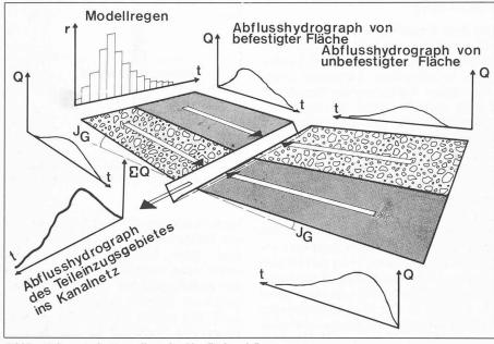
Schematische Darstellung des Oberflächenabflusses
