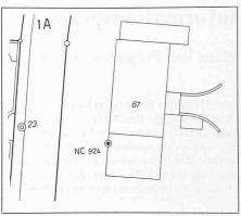
Bild 5. Grundbuchplan. Erstellt von 70% der Fläche der Schweiz. Massstab innerhalb jeder Gemeinde je nach Bodenwert verschieden. Am häufigsten 1: 1000, wie im Beispiel oben.
