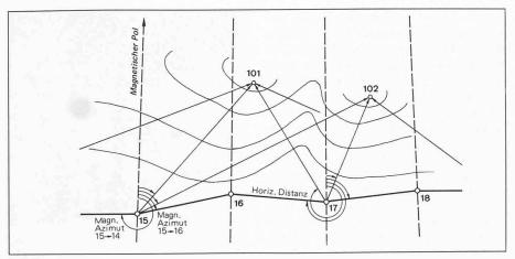
Bild 4 (oben). Prinzip der Routenaufnahme
