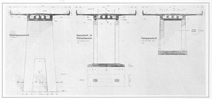
Scheitelquerschnitt, Querschnitt im Stützenbereich, Feldquerschnitt
