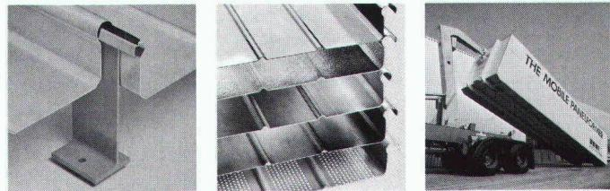
Die BEMO-Profile können mit eingefalzter Gummidichtung ausgerüstet werden. Sie sind in Aluminium, Stahl, Kupfer, Zink und Chromstahl in Baubreiten von 250–600 mm und in Materialdicken von 0,4–1,2 mm lieferbar. Um noch rationeller arbeiten zu können, haben wir die mobile Fabrikation «THE MOBILE PANELFORMER» entwickelt. Mit diesem computergesteuerten Walzwerk fabrizieren wir genau nach Einsatzplan vor Ihrer Haustür. Dadurch können teure Transportkosten eingespart werden.
