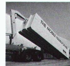
Die BEMO-Profile können mit eingefalzter Gummidichtung ausgerüstet werden. Sie sind in Aluminium, Stahl, Kupfer, Zink und Chromstahl in Baubreiten von 250–600 mm und in Materialdicken von 0,4–1,2 mm lieferbar. Um noch rationeller arbeiten zu können, haben wir die mobile Fabrikation «THE MOBILE PANELFORMER» entwickelt. Mit diesem computergesteuerten Walzwerk fabrizieren wir genau nach Einsatzplan vor Ihrer Haustür. Dadurch können teure Transportkosten eingespart werden.
