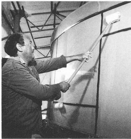
Auf das PVC wird als Haftvermittler zunächst Palatal aufgetragen.
