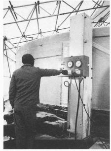
Weitere Glasfasermatten und Rovings (endlose Glasfaserstränge) folgen. Für das Aufbringen der Glasfaserstränge bedient man sich einer zerlegbaren und transportablen Wickelanlage. Die Imprägnierung der Rovings mit Palatal erfolgt in einem separaten Tränkbad
