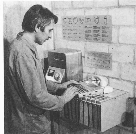
Bild 5. Service-Monteure, der mittels portablen Personal Computer und Akustikkoppler via PTT-Wählnetz von der Zentraleinheit sämtliche Daten für seinen Service-Einsatz abrufen.
