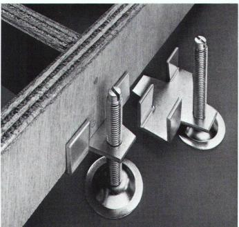
BENDER-Beschläge können sogar einiges mehr. Zum Beispiel der Kreuzwinkel No. 45.465.01 für die Sockel-Nivellierung beim Küchenbau. Er wird erst an Ort und Stelle im Bau auf die Sockel aufgesteckt und muss nicht angeschraubt werden. Dadurch lassen sich sämtliche Sockel rasch und mühelos ausrichten.
