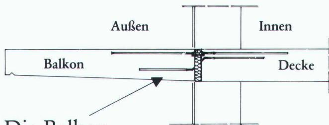
Die Balkondämmplatte mit Bewehrungskorb!
