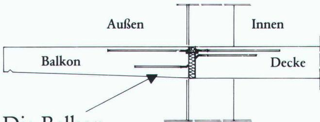
Die Balkondämmplatte mit Bewehrungskorb!
