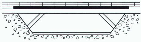
VATEC-Brückenabdichtungen mit den dauerelastischen PUR-Reaktiv-beschichtungen: höchste mechanische Festigkeit; Rissüberbrückung auch bei niedrigen Temperaturen; gute chemische Beständigkeit insbesondere gegen Bitumen, Salz und Alkalien; schubfester Haftverbund mit Beton und Stahl; Kurzzeit-Temperaturbelastbarkeit bis +240°C; nahtlose Spritzapplikation.
