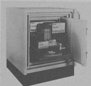
Als bisher weltweit einziges Produkt hat der feuersichere Datenschränke von Rosengrens Typ DC 2.10 den international härtesten 2-Stunden-Test für Datenträgerschränke in Braunschweig erfolgreich bestanden (Gütekennung S 120 DIS nach RAL 626/7). Der Test nach VDMA 24991 lässt eine Höchsttemperatur im Schrankinnern von  $55^\circ\text{C}$
