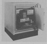
Als bisher weltweit einziges Produkt hat der feuersichere Datenschrank von Rosengrens Typ DC 2.10 den international härtesten 2-Stunden-Test für Datenträgerschränke in Braunschweig erfolgreich bestanden (Güte-klasse S 120 DIS nach RAL 626/7). Der Test nach VDMA 24991 lässt eine Höchsttemperatur im Schrankinnern von 55°C
