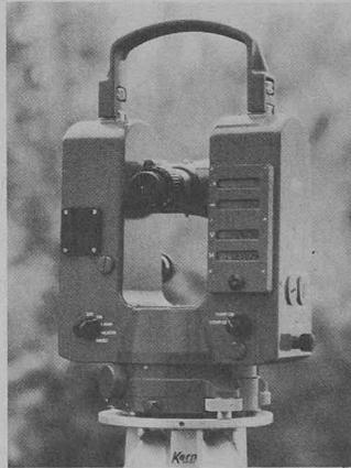
binieren. Wird der E 2 für trigonometrische Höhenbestimmungen eingesetzt, so ist die angezeigte Höhendifferenz automatisch um den Einfluss von Refraktion und Erdkrümmung korrigiert.
