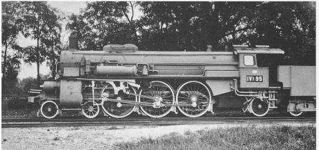
Bild 1. Schnellzuglokomotive Gattung IVh der Badischen Staatsbahnen
