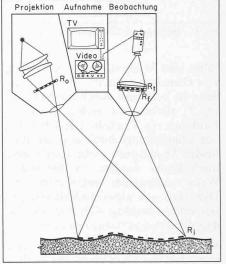
Bild 1. Prinzip der Messung
