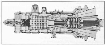
Bild 5. Schnitt durch die Sulzer-Gasturbine Typ 10
