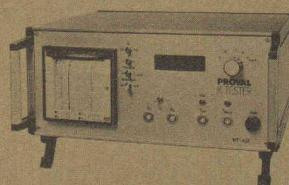
Die technologischen Voraussetzungen für moderne Bauweisen, welche einen günstigen Energiehaushalt ermöglichen, schafft der «Proval K-Tester». Mit dem von der St. Galler Engineering- und Generalunternehmung Provalbau AG entwickelten Gerät können Gebäudehüllen eingehend hinsichtlich ihrer Isolierfähigkeit untersucht werden. Auf-
