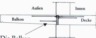
Die Balkondämmplatte mit Bewehrungskorb!
