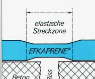
EFKAPRENE®-Brückenabdichtung überbrückt Risse und widersteht dem Tausalzwasser, der Einbauhitze von Gussasphalt und der Schubbeanspruchung
