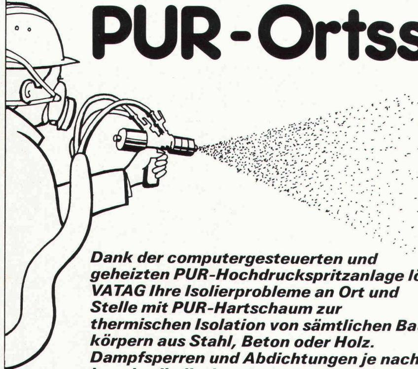
Dank der computergesteuerten und geheizten PUR-Hochdruckspritzanlage löst VATAG Ihre Isolierprobleme an Ort und Stelle mit PUR-Hartschaum zur thermischen Isolation von sämtlichen Baukörpern aus Stahl, Beton oder Holz. Dampfsperren und Abdichtungen je nach bauphysikalischen Anforderungen.
