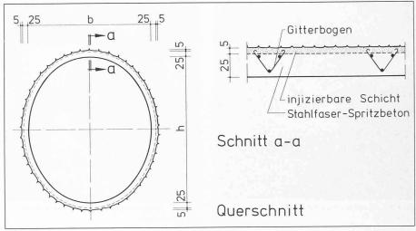
Einschaliger Verkehrstunnel mit Stahl faserspritz beton
