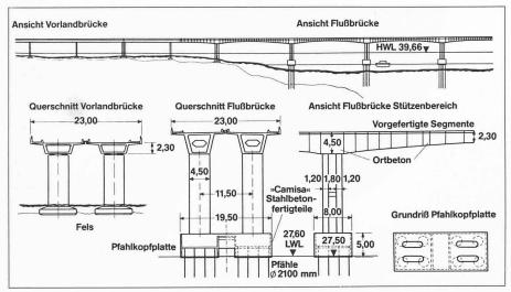
Nigerbrücke Ajaokuta, eine Spannbetonbrücke in Segmentbauweise
