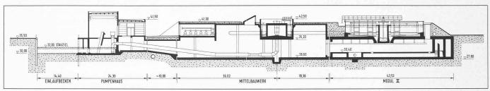
Bild 21. Entphosphatungsanlage, Arbeitsweise, Längsschnitt
