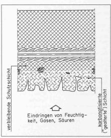
Bild 1. Karbonatisierte Zone innerhalb der Betondeckung
