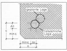
Bild 2. Erklärung der Masse der Betondeckung
