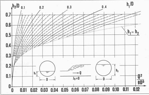
Bild 11. Konjugierte Abflusstiefen im Kreisprofil, kleine Füllungsgrade
