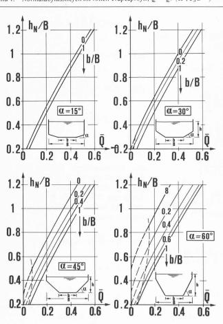
Bild 5. Kritische Tiefen im vollen Trapezprofil;  $\overline{Q} = Q/(\sqrt{gB^5})$
