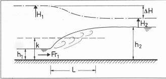
Wassersprung zwischen den beiden Querschnitten 1 und 2 mit h als Abflusstiefe, H als Energiehöhe, k als kritische Tiefe,  $\Delta H$  als Energiedifferenz und L als Sprunglänge
