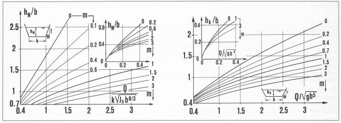
Bild 3. Normalabflusstiefen (links) und kritische Tiefen (rechts) im Trapezprofil
