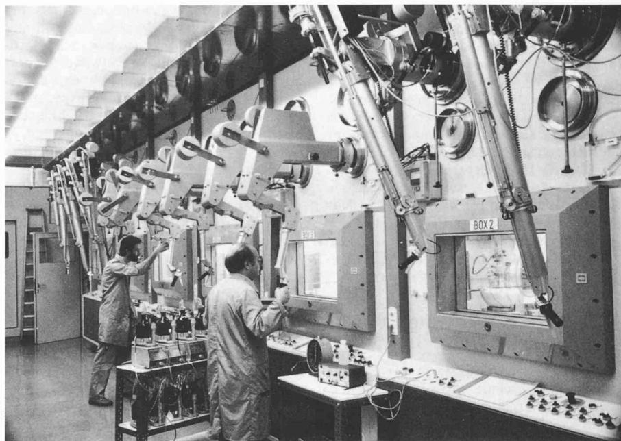
des INE steht. Auf diese Weise wird, wie in der Kerntechnik üblich, durch drei voneinander getrennte Belüftungszonen mit einem nach innen abnehmenden Luftdruck eine Verschleppung luftgetragener Radioaktivität zuverlässig verhindert. Das innerhalb des Containers arbeitende Personal wird von einer 30 cm dicken Stahlabschirmung bzw. von den üblichen 50 cm dicken Abschirm-
