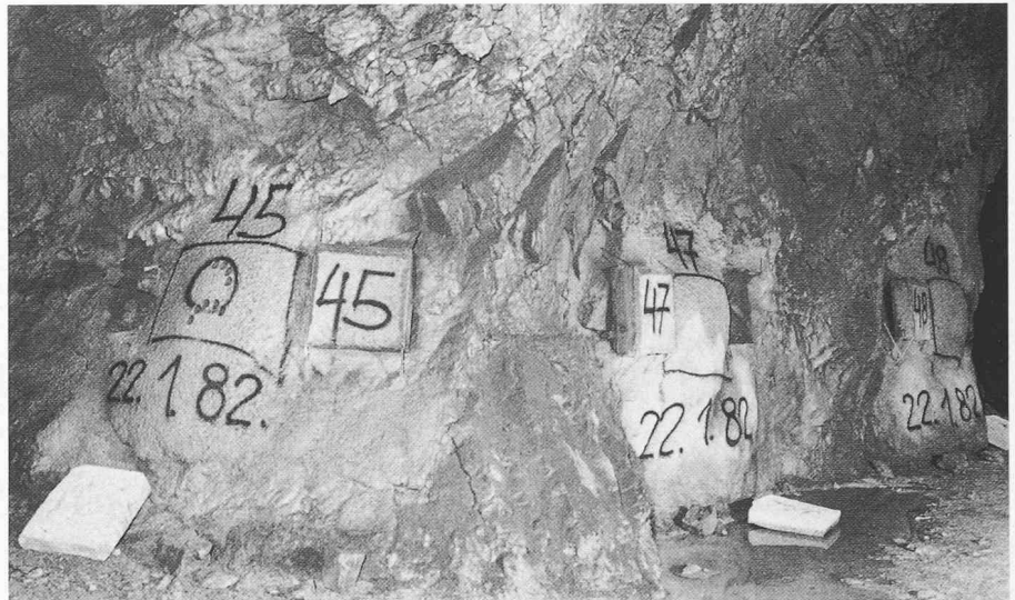
Bild 3. Spritzbetonmuster in der Untertageanlage in Morbio Inferiore (Foto: H. Germond, Lausanne)
