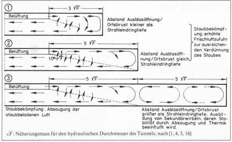
Strömungsstrukturen im Tunnel bei blasender Belüftung und deren Ausnutzung zur Staubbekämp-Bild 3. fung
