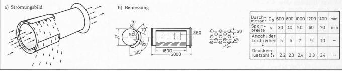
Bild 24. Bemessung von Coanda-Lutten [6, 9]
