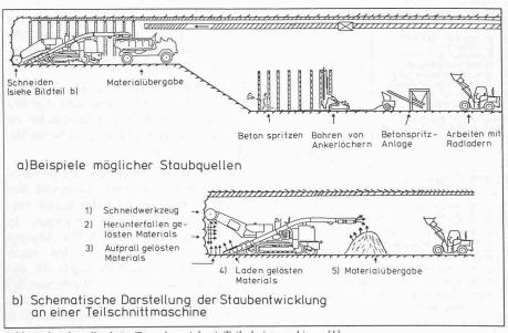
Bild 1. Staubquellen beim Tunnelvortrieb mit Teilschnittmaschinen [1]
