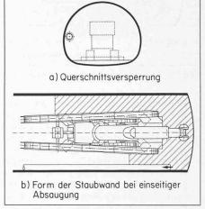
Bild 19. Einfluss vertikaler Versperrungen auf die Staubwand [12]
