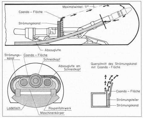
Bild 21. Luftschirm zur Staubeinkapselung an einer Teilschnittmaschine, nach [3, 7, 10]
