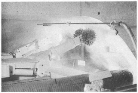
Bild 15. Modellversuch für einen Kalottenvortrieb mit zwei Teilschnittmaschinen, Absaugung des Ammoniumchlorid-Rauches (Simulation für den Staub) über die Absauglutte im Vordergrund. Belüftung  $10.4 \cdot \sqrt{F}$  vor der Ortsbrust in der Firste [1,2,12]
