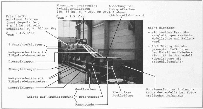
Bild 13. Versuchsanlage der Stuva zur Durchführung strömungsmechanischer Modell-Experimente [1]
