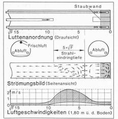
Bild 4 (oben). Belüftungs-/Entstaubungssystem beim Vortrieb eines Tunnels mit Maulprofil-Querschnitt [12]
