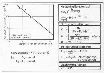
Bild 7. Abnahme der Feinstaub-Konzentration mit dem Abstand von der Ortsbrust; Baulos «Schweinauer Strasse» der U-Bahn Nürnberg; [1, 2]
