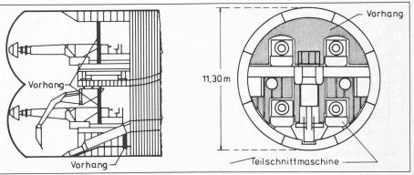
Bild 10. Staubkapselung durch Vorhänge im Rosenberg-Tunnel, St. Gallen [1]
