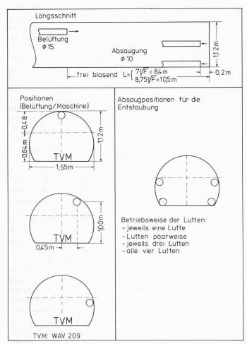
Bild 14. Versuchsaufbauten im Vollquerschnitt [1, 2]
