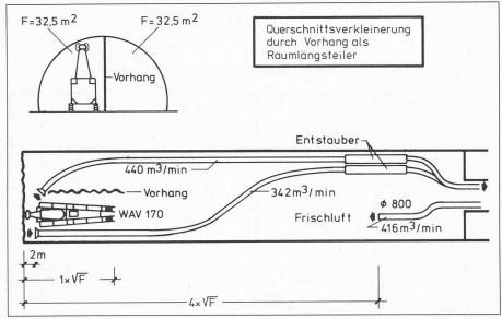
Auf einer weiteren Baustelle [15] wurde eine Art Längsteiler des Tunnels gewählt (Bild 11). Der erste Versuch war
