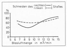
Absenkung der Staubkonzentra-Bild 22 (oben). tion im Bereich einer Teilschnittmaschine durch den Einsatz eines Coanda-gesteuerten Luftschirms [10]
