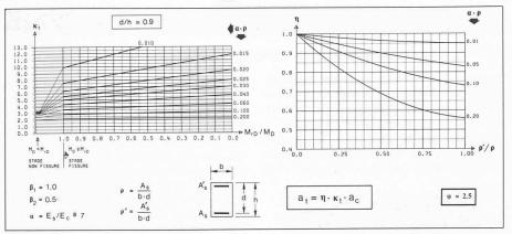
Bild 3. Beispiel einer praktischen Rechenhilfe [3] für die Abschätzung der langzeiten Durchbiegungen unter ständigen Lasten
