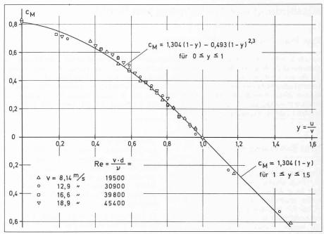
Bild 3. Anzeige des Windmessers bei Start aus der Ruhe, konstante Anblasgeschwindigkeit v
