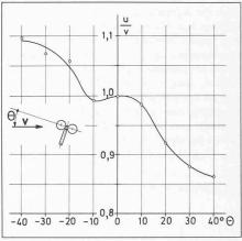
Bild 4. Einfluss der Schräganblasung, u Anzeige des Instruments, v Anblasgeschwindigkeit. 5 m/s ≤  $v \le 20 \,\mathrm{m/s}$
