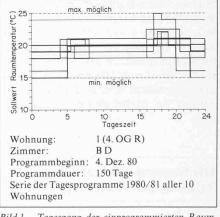
Bild 1. Tagesgang der einprogrammierten Raumlufttemperatur der Benutzer des modularen Regelsy-
