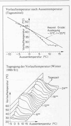
Bild 2. Vorlauftemperaturen im Haus mit dem modularen Regelsystem
