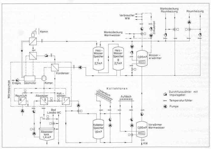
Bild 1. Prinzip-Schema des Wärmekollektivs
