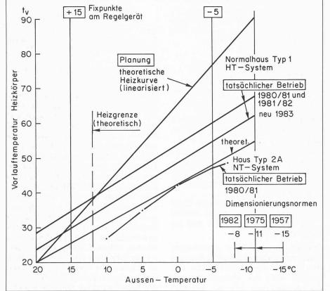
werden nur einstufig betrieben, obwohl ihr zweistufiger Betrieb technisch möglich und energetisch sinnvoll ist; beide Kessel sind dauernd warm und können erst nach einem Umbau der Warmwassersteuerung so gefahren werden, dass bis ca. 0 °C Aussenlufttemperatur ein Kessel abgestellt bleibt. Die effektive Dauer der Heizperiode lässt den Schluss zu, dass eine Heizgrenze von ca. 14 °C gefahren wird, anstatt 10 °C, wie sie bei gut wärmegedämmten Bauten möglich ist.
