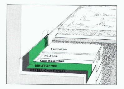
Ob im Grundwasser oder auf dem Dach, die ausgereifte Verbia-Abdichtungstechnik schützt zuverlässig vor Wasserinfiltrationen und Kondensationsschäden. Die hier ausgeführte Unterterrain-Abdichtung mit der 5 mm starken Elastomer-Bitumenbahn
