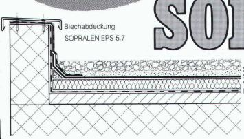
Schutzschicht SOPRALEN EJ 3.5 + EV 3.2 Wärmedämmschicht Dampfsperre
