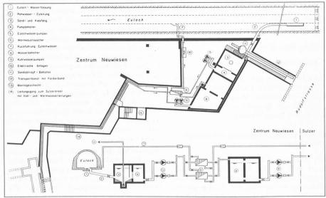
Bild 18. Die Wasserentnahmeanlage im Rohbau
