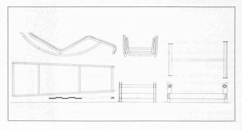
Bild 7. Chaise-longue, Untergestell in Eisen, Obergestell in Stahlrohr. Die verschiedenen Etappen von Gestell und Polster sind ablesbar
