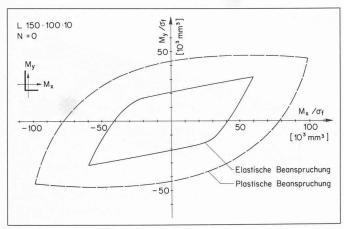
Bild 4. Elastische bzw. plastische Spannungsverteilung
