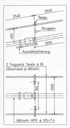
Bild 4 (links). Leitungsaufhängung
