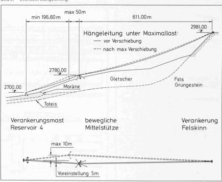
in Längs- oder ±10 m in Querrichtung muss die Mittelstütze in ihre Ausgangslage zurückversetzt werden. Die Spannweiten der Hängeleitung betragen in der Ausgangslage bzw. nach Erreichen der zulässigen Längsverschiebung der Mittelstütze:
