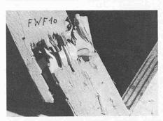
Bild 14. Bruch der Zugdiagonalen ausgehend von einem Ast im Anschlussbereich
