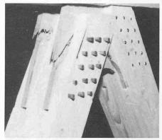
Bild 18. Bruch einer Knotenplatte aus Sperrholz (Verbindungsmittel = Hartholzstifte)
