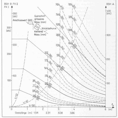
Bild 25. Bemessungsdiagramm für Druck- und Zugdiagonalen mit BSB-Reihenanschlüssen
