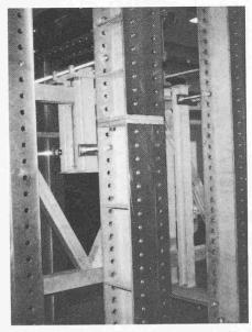
Bild 6. Zusätzliche mittlere Abstützung des Ober-
