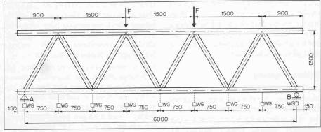
System, generelle Abmessungen und Krafteinleitung der untersuchten Träger
