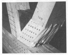
Bild 12. Versagen der Druckdiagonalen im geschwächten Anschlussbereich
