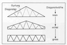
Bild 1. Häufig vorkommende Trägerformen für Dachtragwerke
