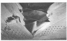
Bild 11. Ausknicken bei dünnen Knotenblechen (Greim)
