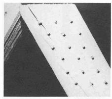
Bild 16. Aufspalten der Holzteile bei Nadelholz
