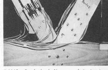
Bild 15. Bruch durch Nettoquerschnitt in einem Diagonalstab aus Buchen-BSH; beachte zufälliges Zusammentreffen zweier Keilzinkungen mit Nettoquerschnitt
