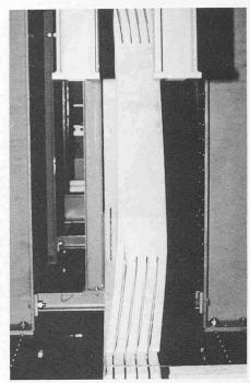
Bild 13. Knickfigur des abgesetzten Druckstabes
