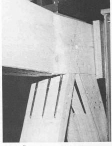
Örtliches Knicken des Druckgurtes im ge-Bild 7. schlitzten Knotenbereich
