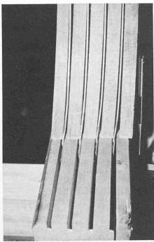
Bild 10. Ausknicken bei zweiteiligen Knotenblechen (Blumer Original)
