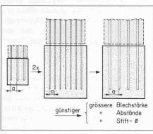
Bild 20. Tragkraft pro m3 Holzvolumen
