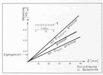
Bild 6. Durchbiegung der räumlich bewehrten Platten
