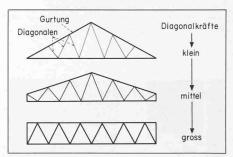
Bild 1. Häufig vorkommende Trägerformen für Dachtragwerke
