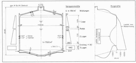
Bild 4. Faulbehälter: Querschnitt, Belastungsfälle, Schnittkräfte
