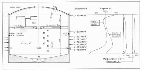
Bild 3. Voreindicker: Querschnitt, Belastungsfälle, Schnittkräfte
