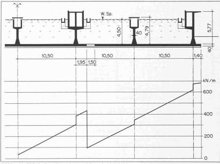
Bild 1. Nachklärbecken: Querschnitt und Spannkraftverlauf
