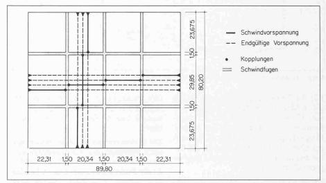
Bild 2. Belüftungsbecken: Schema Vorspannung Bodenplatte
