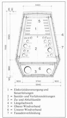
Querschnitt des Hochkanals
