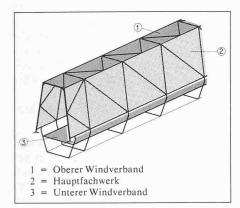
Bild 3. Isometrie des statischen Systems
