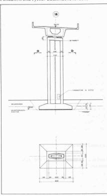
querschnitte sind wegen der relativ geringen Gesamtbreite von 12,50 m pro Brücke und aus Unterhaltsgründen einzellig.
