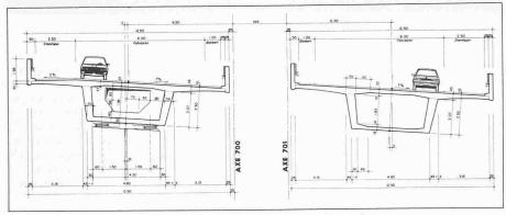
Querschnitte Badschachenbrücke, links Stützenquerschnitt, rechts Feldquerschnitt
