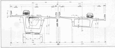
Querschnitte Aarebrücke, links Stützenquerschnitt, rechts Feldquerschnitt
