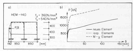
Stahlrahmen, System und Last-Durchbiegungs-Diagramm
