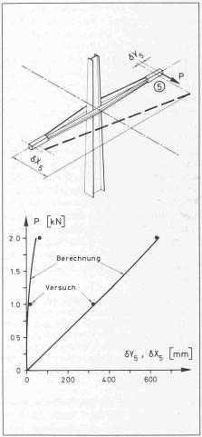
Der Leitungsmast aus Bild 8 wurde mit der Last P im Versuch und in der Berechnung belastet. Der Versuch wurde an einem Masten im Massstab 1:1 durchgeführt. Die Punkte im Diagramm zeigen die Resultate für eine Deformation in X und Y. Die ausgezogenen Linien stellen die Resultate der Computerberechnung dar [15]
