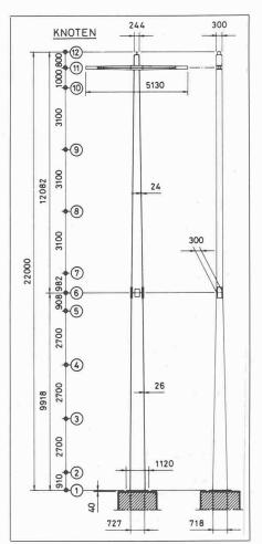
Geometrie eines Masten für Hochspannungsleitungen einer Standard-Reihe. Vor dem Einsatz dieses Typs wurde ein Exemplar im Versuch getestet. Gleichzeitig wurde eine Computerberechnung durchgeführt. Die Ziffern bezeichnen die Knoten, wie sie für das Computerprogramm [14] erforderlich waren [15]
