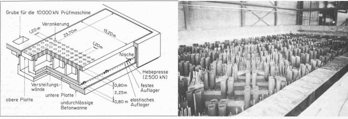
Bild 6. Versuche in wahrer Grösse im Labor oder an Ort und Stelle sind ein Hilfsmittel, das reale Verhalten von ganzen oder Teilen von Bauwerken zu erfassen. Das Photo zeigt den sogenannten Aufspannboden in der Versuchshalle der ETH Lausanne
