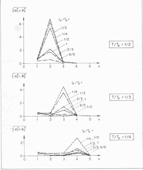
Bild 6. Amplituden der verschiedenen Schwingungsanteile eines Einmassenschwingers für verschiedene Verhältnisse  $T/T_p$  und  $t_p/T_p$ , berechnet für ein Dämpfungsmass  $\xi = 0.020$
