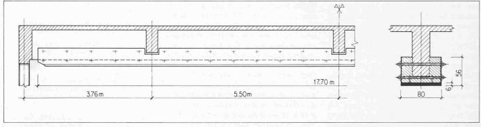
Bild 7. Ansicht und Ouerschnitt der ausgeführten Sanierungslösung
