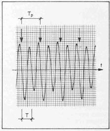
Bild 2. Ausschnitt aus Durchbiegungs-Aufzeichnung MP3 mit eingetragenen mutmasslichen Zeitpunkten des Maximums der Stosskraft, Anregungsperiode Tp und Eigenperiode  $T = T_p/2$
