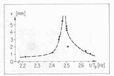
Beispiel einer Resonanzkurve: Deckendurch-Bild 3. biegungen v in der Mitte des Unterzuges U5 (MP3) in Fuktion der Anregungsfrequenz 1/Tp
