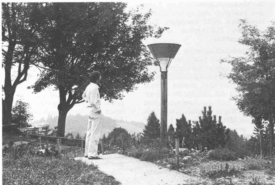
Die Station Bachtel ist mit 1110 m ü.M. der höchstgelegene Niederschlagsmessplatz im Kanton Zürich. Aufgrund der Gipfelflage sind die Messungen besonders dem störenden Einfluss des Windes ausgesetzt. Um diesen Einfluss möglichst klein zu halten, werden die Regenmesser in solchen Fällen mit einem Windschutzring versehen.
