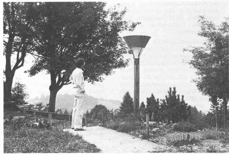
Die Station Bachtel ist mit 1110 m ü.M. der höchstgelegene Niederschlagsmessplatz im Kanton Zürich. Aufgrund der Gipfellage sind die Messungen besonders dem störenden Einfluss des Windes ausgesetzt. Um diesen Einfluss möglichst klein zu halten, werden die Regenmesser in solchen Fällen mit einem Windschutzring
