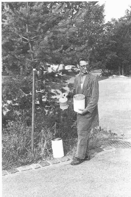
Messplatz der Station Wald-Faltigberg (908 m ü.M.). Der in der Sammelkanne (siehe rechte Hand des Beobachters) aufgefangene Niederschlag wird alle 12 Stunden in ein Messglas umgeschüttet und die Menge an einer Skala abgelesen. – Die gut windgeschützte Station besitzt im Zeitraum 1881–1979 den grössten mittleren, gemessenen Jahresniederschlag im Kanton Zürich (1680 mm).
